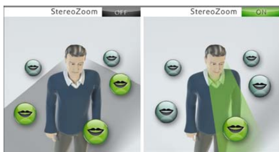
Ilustración 6: Los micrófonos direccionales monaurales tienen una orientación hacia delante amplia (haz gris) mientras que StereoZoom crea un haz muy orientado (verde) hacia delante para centrarse en una sola voz de entre muchas.
